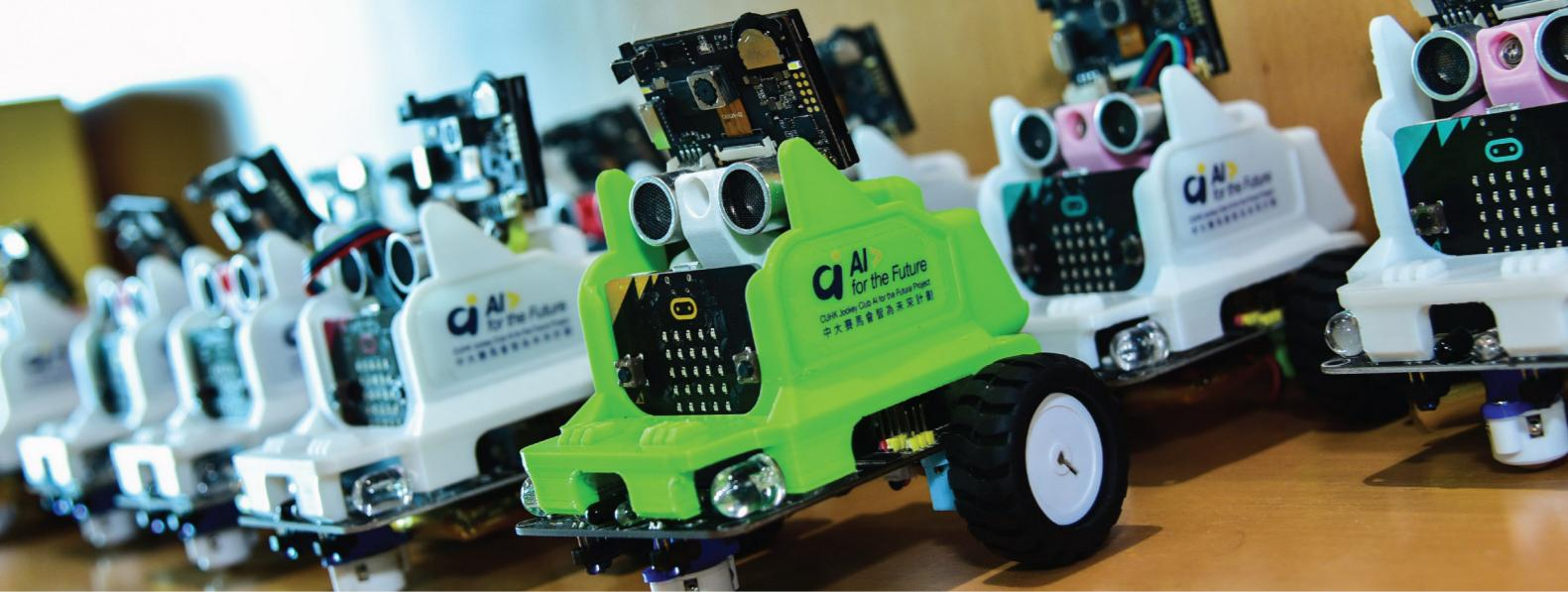
CUHK-JC iCar採用圖形化編程語言，為AI初學者製造了一個門檻較低而且有趣的入門AI工具體驗。除了內置的六項AI功能，包括AI人臉識別、物件追蹤、物件識別、線條追蹤、顏色識別和標籤識別，計劃特別為CUHK-JC iCar設計三個內置實驗，包括人臉跟蹤、手畫線循跡和道德困境實驗，希望教師和學生可以明白如何將書本學到的編程知識應用到實驗製作，並強化這方面的能力。
